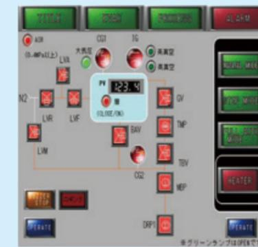
排気系操作も大気から高真空、熱処理完了まで完全自動操作が可能。加熱の昇温、保温、降温は任意に設定可能で、設定もタッチパネルにより簡単にプログラム設定可能。
